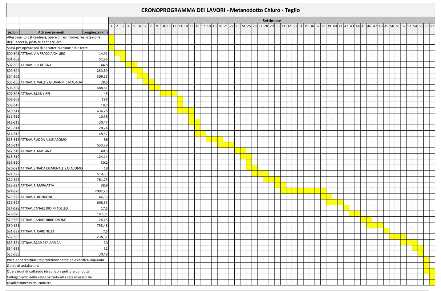
N.B. I lavori di attraversamento fluviale in sub-alveo dovranno essere eseguiti durante il periodo di minor afflusso d'acqua che in fase progettuale si stima compreso tra novembre e marzo nel rispetto comunque delle condizioni meteorologiche e delle variazioni di portata dovuta ai rilasci degli invasi ad uso idroelettrico confluenti nel reticolo idrico di interesse.
